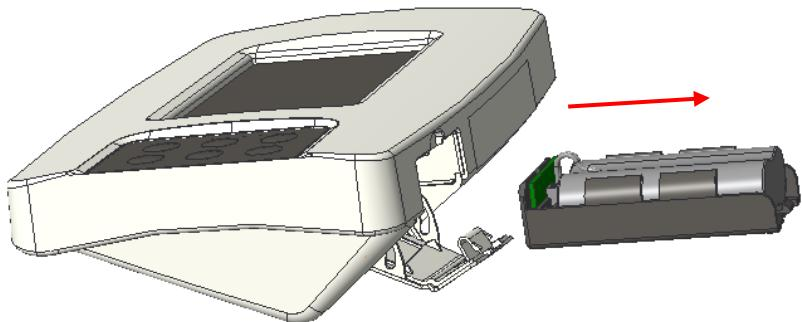
3. 按下電池盒的固定座 ( 圈圈標示處 ) · 將充電電池包稍微拉出 ( 請勿完全拉出來 )
