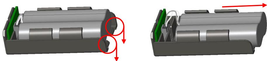
4. 拔掉電線插座，取出充電電池包。更換新的充電電池包後，再接上電線插座
