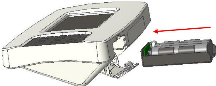
6. 電池盒裝進去後，關閉電池盒蓋。試圖開機，確認是否正確安裝電池
