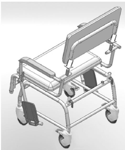
3. Stecken Sie die E-Typ-Clips in die Öffnung, um die Rückenlehne zu sichern
