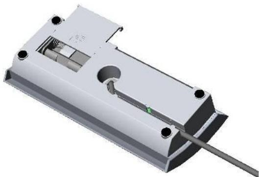
2. Débranchez le câble de la batterie rechargeable du connecteur dans le compartiment de la batterie
