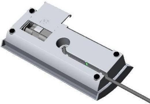
2. Akkukabel vom Stecker im Batteriefach abziehen
