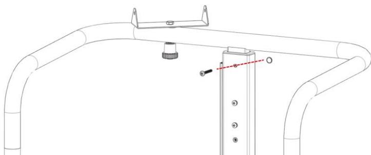
4、秤子傾斜，使用圓頭螺絲將左右圓柱固定於秤台底部支撐片上
