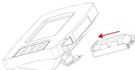
6. 電池盒裝進去後，關閉電池盒蓋。試圖開機，確認是否有正確安裝電
