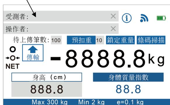
5. 引導受測者上秤，並站立在秤台上。幾秒鐘後，機器會取得平均重量，並且鎖定重量值。此時受測者可下秤，螢幕會持續顯示量測重量
