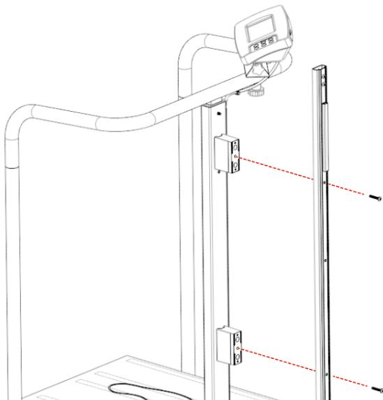
3、將超音波探頭套入[上尺管]，並使用螺絲固定
