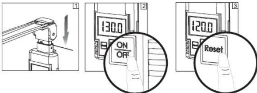
Deslize a haste de medição completamente para baixo. Ligue o HM200D usando a tecla **[ON/OFF]** . Se a exibição da altura não estiver em "120cm", pressione a tecla **[Reset]** para calibrar para 120cm.
