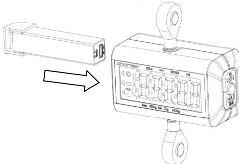
Quando a energia estiver baixa, recarregue a bateria usando a porta micro-USB. Quando a luz da porta estiver piscando **em vermelho**, a bateria está sendo carregada. Quando a luz da porta estiver estável **em verde**, a bateria está totalmente carregada.
