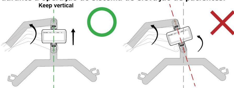
Mesmo que a balança de elevação esteja completamente vertical quando instalada, se ela for dobrada em qualquer ponto da operação (por exemplo: o sistema de elevação do paciente eleva o paciente a um ponto mais alto para medição do peso), o mesmo risco de quebra se aplica.
