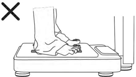
Les vêtements empêchent les talons d'entrer en contact avec les électrodes arrière.
