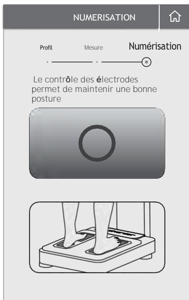
14. L'appareil confirme automatiquement que les électrodes des pieds sont en contact. Un cercle jaune apparaît si tout est correct.
