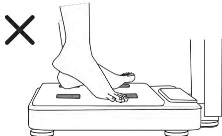
Contact incorrect de l'électrode de pied
