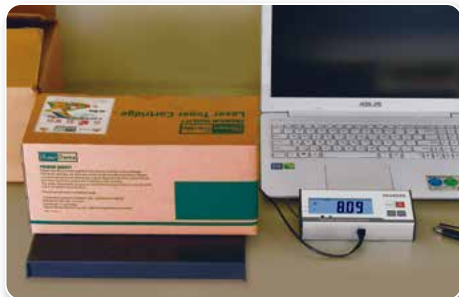
運用USB傳輸線將重量傳輸至電腦，進行自動化的紀錄
