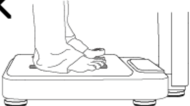
Los talones no hacen contacto completo con los electrodos traseros debido a la ropa.
