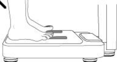
Los pies no están en contacto completo con los electrodos delanteros.
