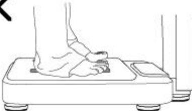
Los talones no hacen contacto completo con los electrodos traseros debido a la ropa.
