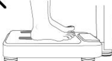
Los pies no están en contacto completo con los electrodos traseros
