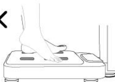
Contacto incorrecto con los electrodos de los pies
